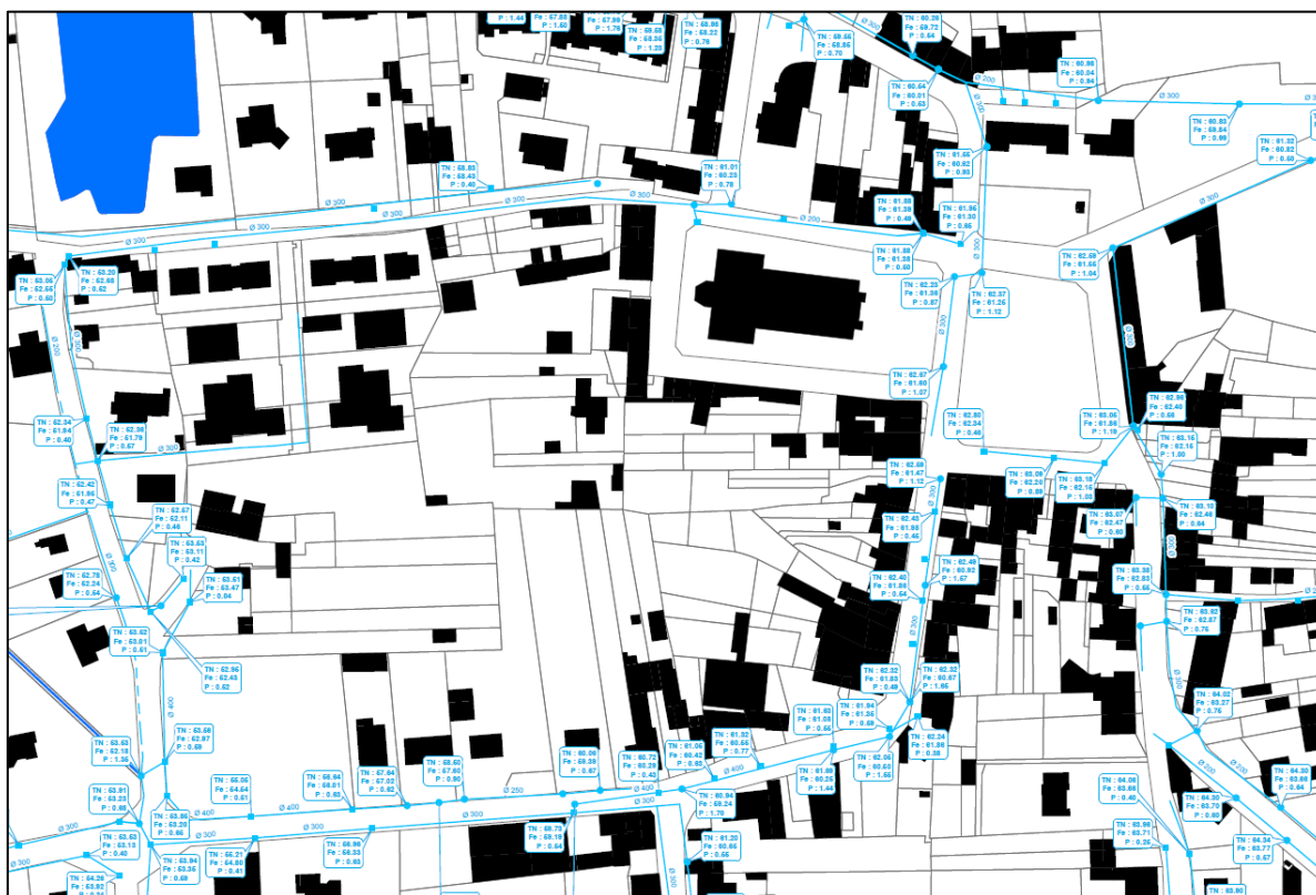
Carte 3 : Extrait du plan des réseaux eaux pluviales de la commune de Bains-sur-Oust
